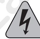
Este símbolo tiene el propósito de alertar al usuario de la presencia de **VOLTAJE PELIGROSO** que no tiene aislamiento de la caja y que puede tener una magnitud suficiente para constituir riesgo de descarga eléctrica.
