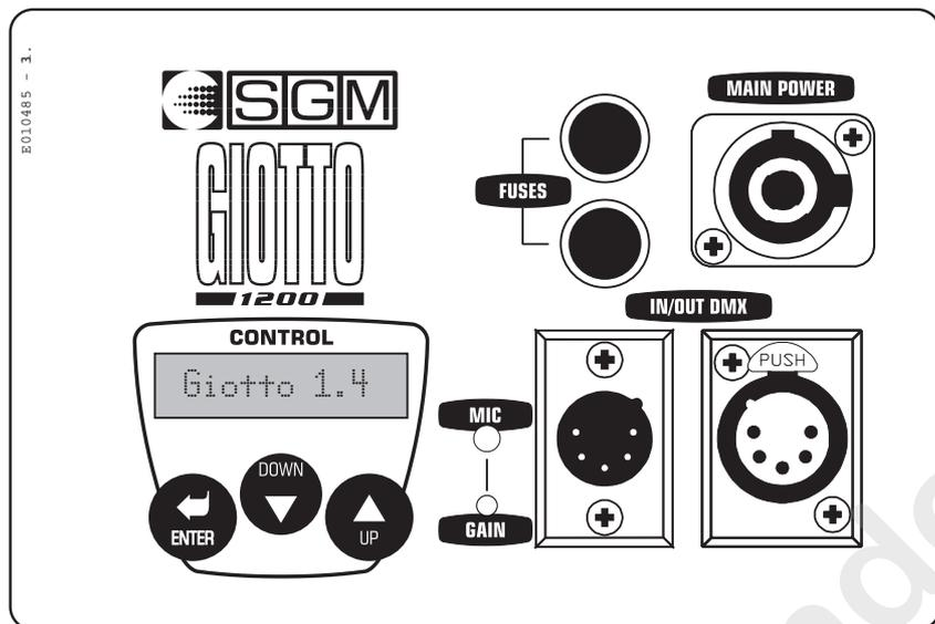
Tres teclas situadas debajo del dispositivo visualizador permiten seleccionar y utilizar los diversos submenús que componen el menú principal.
