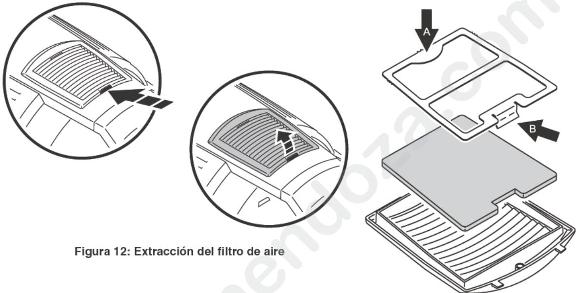
Figura 12: Extracción del filtro de aire
