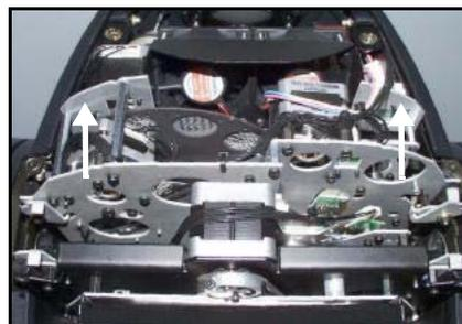
Figure 14: Desbloquear y extraer el módulo
