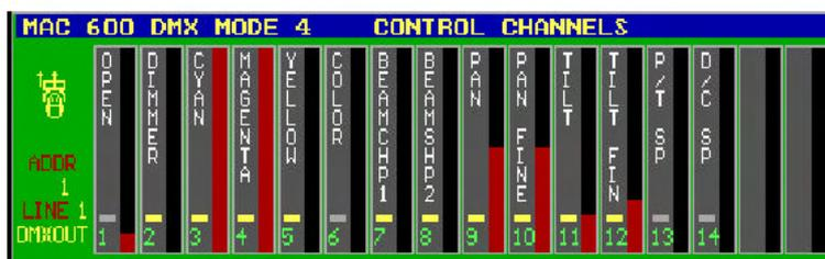
Un canal que puede realizar fade está marcado con una cajita amarilla. Un canal que “salta” tiene una marca gris.
