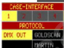
Esta ventana nos muestra la Salidas disponibles (INTERFACE) y para controladores antiguos, también los PROTOCOLOS. *Selecione mediante la bola una salida y un protocolo.* La Salida 1 corresponde a los canales 1 a 512, la salida 2 a los canales 513 a 1024, la salida 3 a los canales 1025 a 1536 y la salida 4 a los canales 1537 a 2048.
