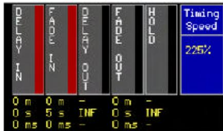
Durante el show, es posible acelerar o ralentizar la velocidad del cue fading desde 0% al 1,000%. Por defecto, el 'timing speed' (velocidad) está fijado al 100%.
