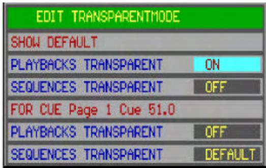
El SHOW DEFAULT es la configuración por defecto del controlador (opciones: ON o OFF). Para cambiarlo, debemos resaltarlo mediante las teclas *[2?]* o *[8?]* y seleccionar la tecla *[EDIT]*.
