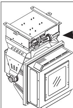
**NOTA:** Per installazioni a soffitto, ruotare la forcella intorno al proiettore come mostrato in figura. Il proiettore **NON DEVE** essere capovolto.
