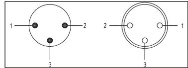
Verificate che i fili siano correttamente collegati nel connettore e che essi non ne tocchino il guscio (utilizzare filo schermato). Al fine di assicurare l'impermeabilità dell'alloggiamento della scheda, si consiglia di posizionare i cavi dei connettori DMX tra i due coperchi come rappresentato nelle seguenti figure.
