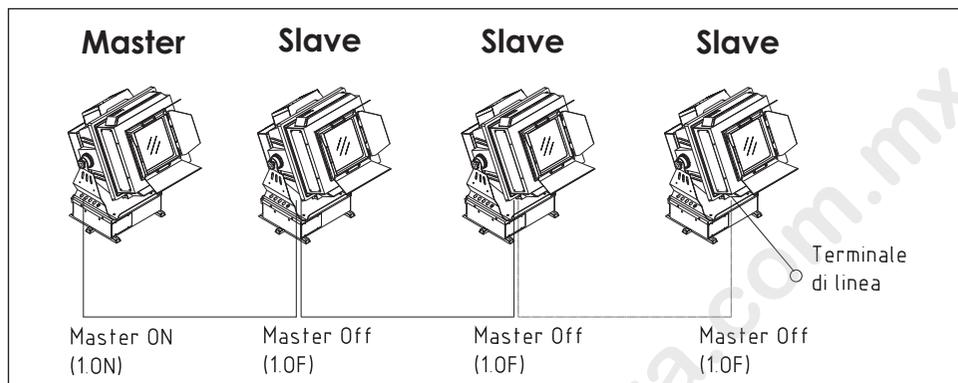
Il terminale di linea consiste in una resistenza, inserita tra i due pin Signal (pin 2 e 3) del connettore di uscita posto alla fine della linea DMX. Ciò consente di evitare il malfunzionamento della linea stessa. Consigliamo una resistenza da 120 Ohm.
