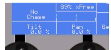
Cualquier otro atributo de las luminarias seleccionadas puede ser controlado oprimiendo el botón adecuado y girando las ruedas. La pantalla mostrará cuales funciones controlarán las dos ruedas.
